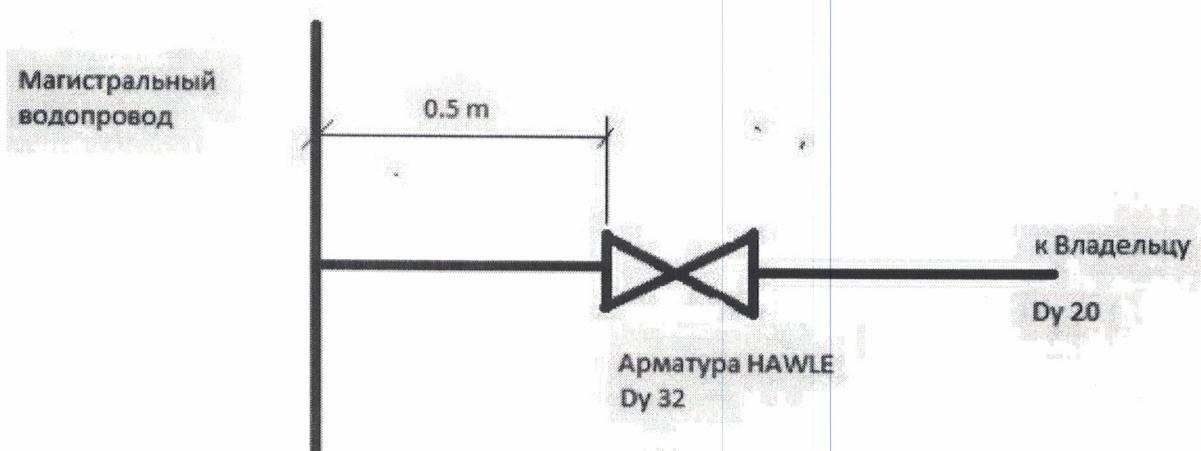
1.3 Границей балансовой принадлежности и эксплуатационной ответственности Владельца водопроводной сети является запорная арматура на месте врезки в водопровод-отвод от магистральной сети.
